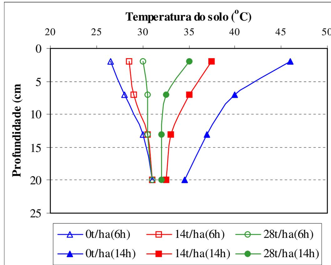
A figura acima mostra a variação da temperatura do solo para dois horários do dia e até a profundidade de 20cm, para diferentes graus de cobertura com palha de café. Observe que o solo sem cobertura apresentou uma amplitude térmica (variação entre 6 e 12h) muito maior do que para o solo coberto com mulch. Os resultados confirmam que quanto maior a cobertura com mulch, maior o isolamento proporcionado.
