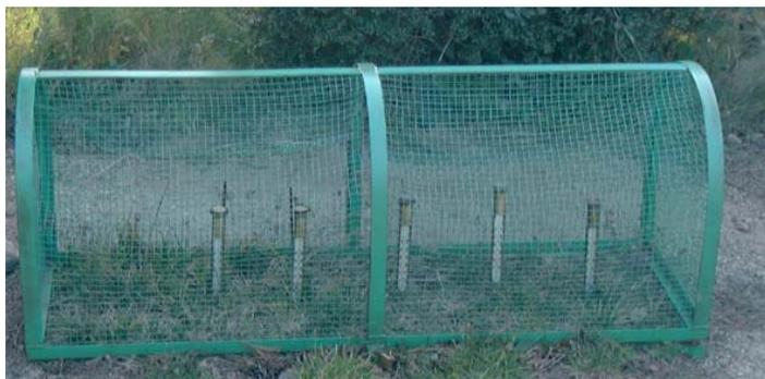
**Geotermômetros instalados em solo desnudo**
