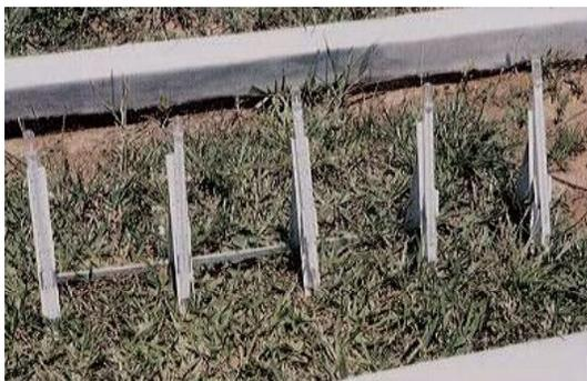
**Geotermômetros instalados em gramado**
