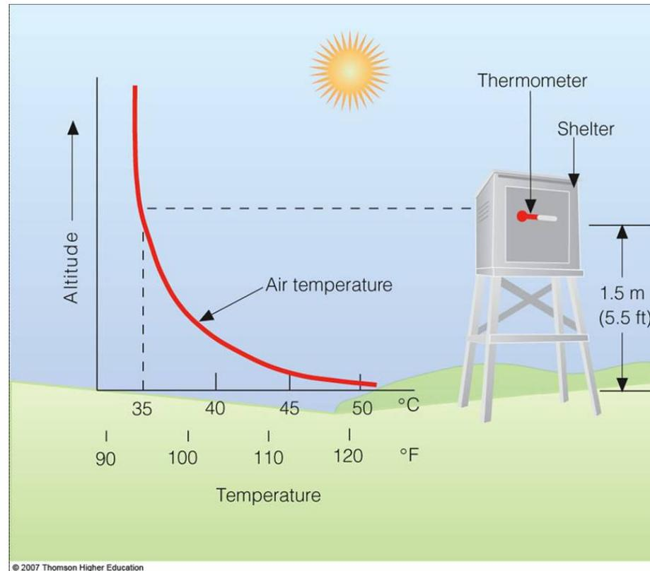
A temperatura do ar varia espacialmente também na vertical. Como tanto o aquecimento como o resfriamento do ar se dão a partir da superfície, durante o dia a tendência é da temperatura do ar ser maior próxima à superfície e menor com a altura. Já de madrugada, essa situação se inverte, sendo a temperatura menor próxima à superfície e maior com o aumento da altura. Esses gradientes verticais de temperatura são apresentados na figura a seguir.
